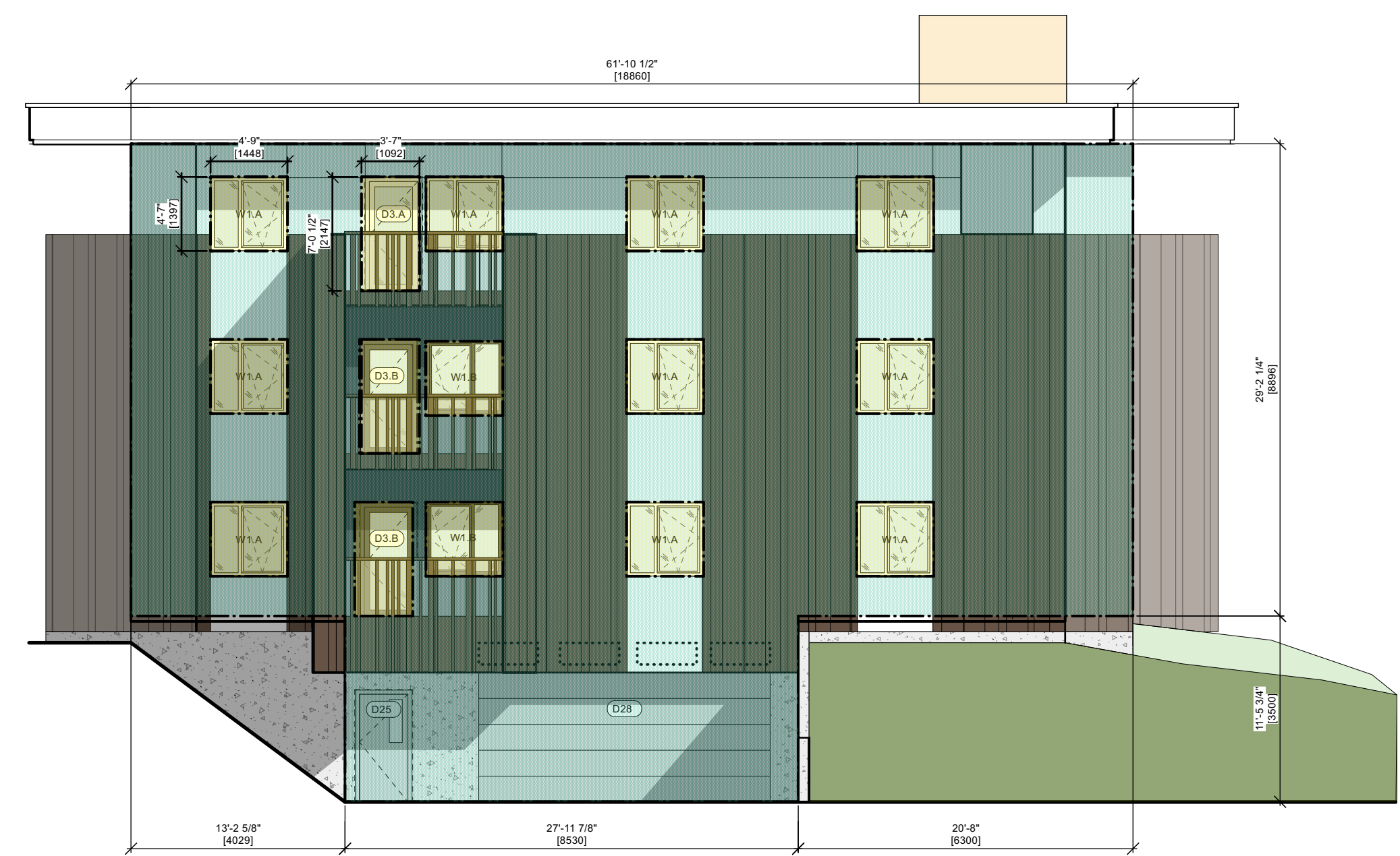
2 NORTH ELEVATION Scale: 1/8" = 1'-0"
